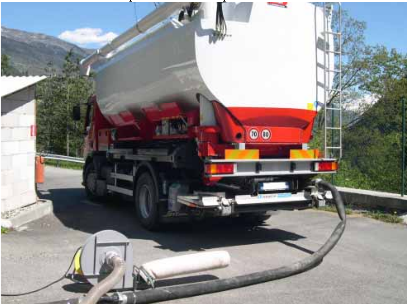
Ventilatore munito di filtro per la raccolta delle polveri
